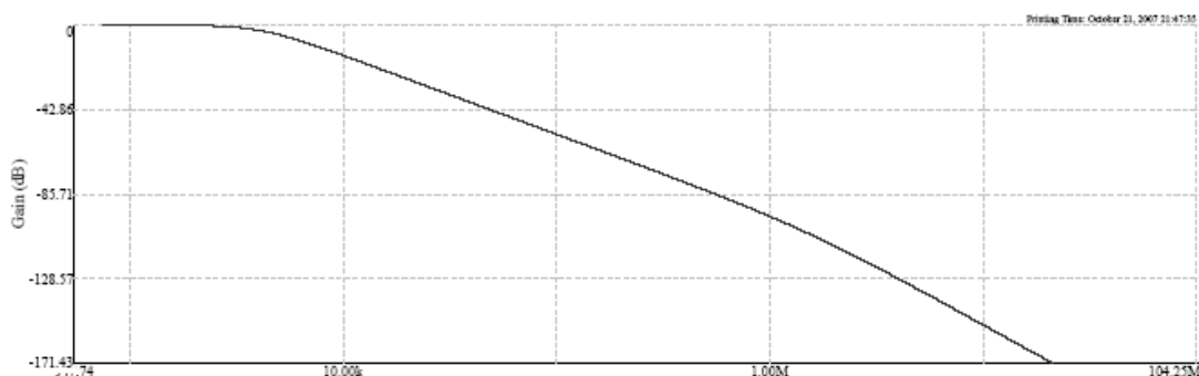
Figura 5.19 – Diagrama de Bode do filtro passa-baixa do circuito demodulador AM.
