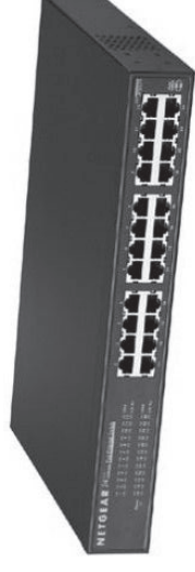
Figura 14.5: Switch Ethernet ativo.
