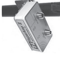
Figura 15.2: Amplificador RF montado entre o Ponto de Acesso e a antena.
