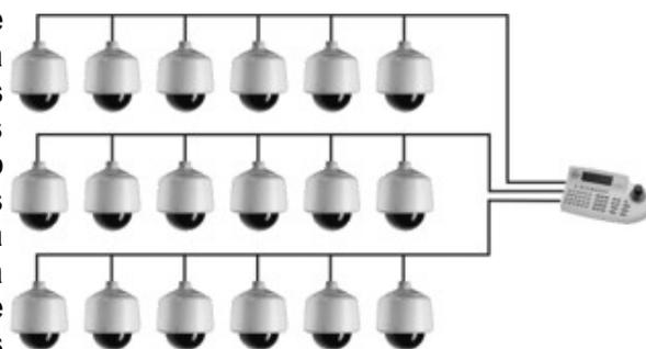
Alguns sistemas de speed domes, como o Coaxitron da Pelco e o Bilinx, permitem a transmissão dos sinais de vídeo e controle sobre o cabo coaxial (conversor de fibra ótica ou par trançado), ou seja, o sinal de controle é multiplexado sobre o sinal de vídeo. A vantagem deste tipo de sistema é que pode-se aproveitar um cabeamento em bom estado para a conexão de uma câmera speed dome.
