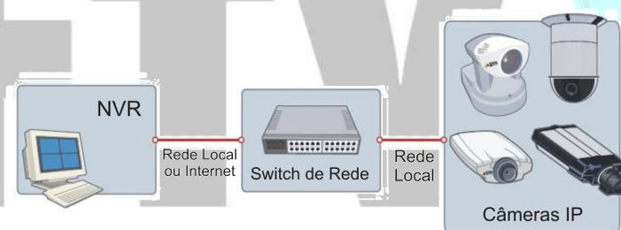
Uma câmera convencional digital tem uma resolução máxima de 640 x 480 com aproximadamente 300.000 Pixels ou 0,3 Megapixel, já uma câmera IP poderá ter resoluções de até 2592 x 1944 ou aproximadamente 5Mpíxel. Com resoluções desta dimensão a capacidade de reconhecimento e verificação de detalhes em uma imagem fica muito facilitada, mas acima de tudo são possíveis novos recursos como movimentação no escopo da área de visualização, zoom em parte da imagem, etc.
