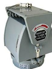
Agregamos a isso ainda, a fácil identificação da direção do PTZ, que pelo seu design e forma são inconfundíveis, assim como sua direção de posicionamento. Sua baixa velocidade de movimentação, ausência de funções mais avançadas, como posições memorizadas, percursos programados, etc.
