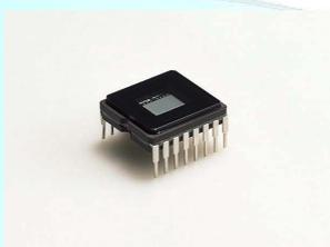
O Obturador Eletrônico do sensor CCD tem a importante função de compensar a iluminação, obtendo uma imagem com melhor qualidade e confiabilidade, em locais com variação intermediária de iluminação, dispensando em alguns casos, o uso de lentes auto-íris.
