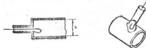
Acoplamento através de abertura
