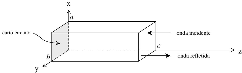
A composição das ondas incidente e refletida forma uma onda estacionária na direção z:
