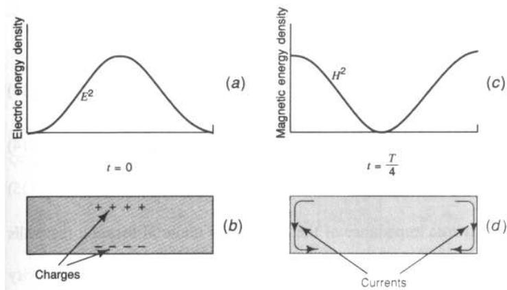
Se não há perdas, a energia oscila indefinidamente entre as formas elétrica e magnética, permanecendo com valor total constante. Na prática, entretanto, sempre há alguma perda, seja nas paredes condutoras, no dielétrico ou devido aos acoplamentos externos. Desta forma, a energia total decresce exponencialmente com o tempo.
