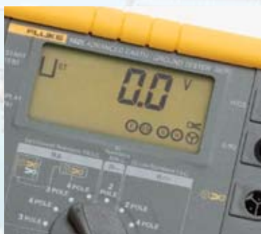
Use o Fluke 1625 para examinar o estado dos sistemas de aterramento.
