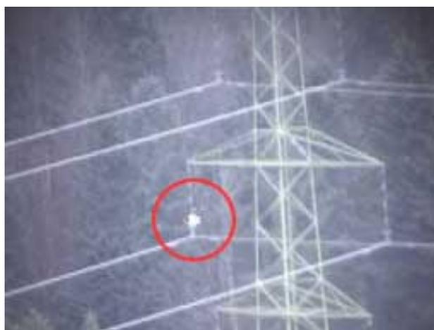
Figura 8.1.2.2 - Detecção do efeito corona em uma linha de 380 kV em tempo nebuloso.
