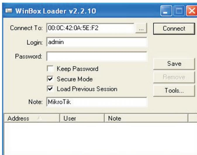
2) Depois de acessar o equipamento vá no menu wireless, afim de configurarmos o modo, o canal e o ssid do equipamento.
