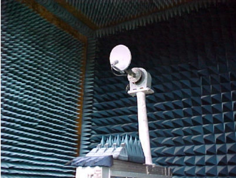
O diagrama pode ser obtido tanto pelo deslocamento de uma antena de prova em torno da antena que se está medindo, como pela rotação desta em torno do seu eixo, enviando os sinais recebidos a um receptor capaz de discriminar com precisão a frequência e a potência recebidas
