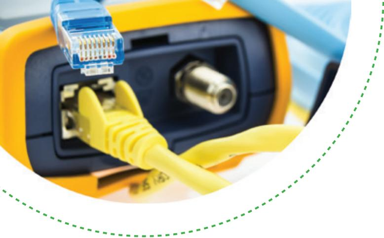
» **Teste de cabo:** é possível encontrar no mercado equipamentos de baixo custo que validam um cabo já conectorizado. Esse teste auxilia na verificação rápida de um determinado trecho cabeado. Além disso, um testador ajuda muito a identificar problemas após a instalação e nas medições preventivas como envelhecimento, rompimento, problemas de conexão, erro na sequência correta de montagem dos pares, etc.
