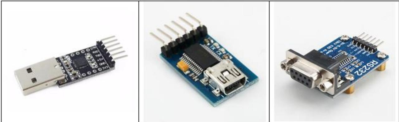
Figura 1- Opções comerciais de adaptadores Serial para TTL
