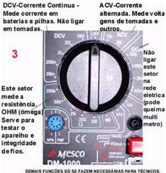
Campo **DCV** – Mede Corrente Contínua – Geralmente localiza-se à esquerda – foto ao lado – é usado para medir pilhas e baterias. Basta encostar qualquer uma das duas ponteiros em um dos pólos da bateria e a outra no outro pólo. Para medição de pilhas e baterias pequenas e médias, basta apontar o ponteiro do multímetro para a posição 20. Não ligar este campo em tomadas.
