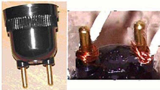
5 – Após este passo, conecte o fio da lâmpada com o bocal nos orifícios do fase e do terra (Não existe polaridade quando se liga lâmpada diretamente na tomada).
