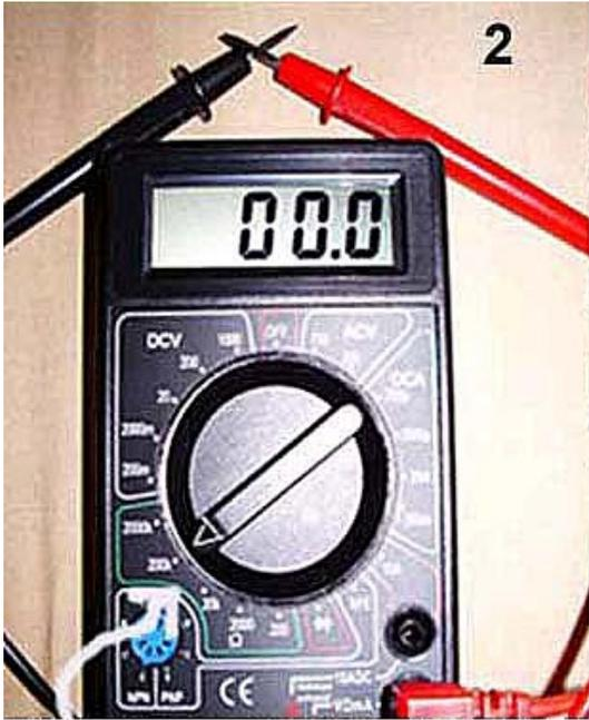
Direcione o ponteiro do multímetro para o símbolo de OHM - Ômega  $\Omega$ .
