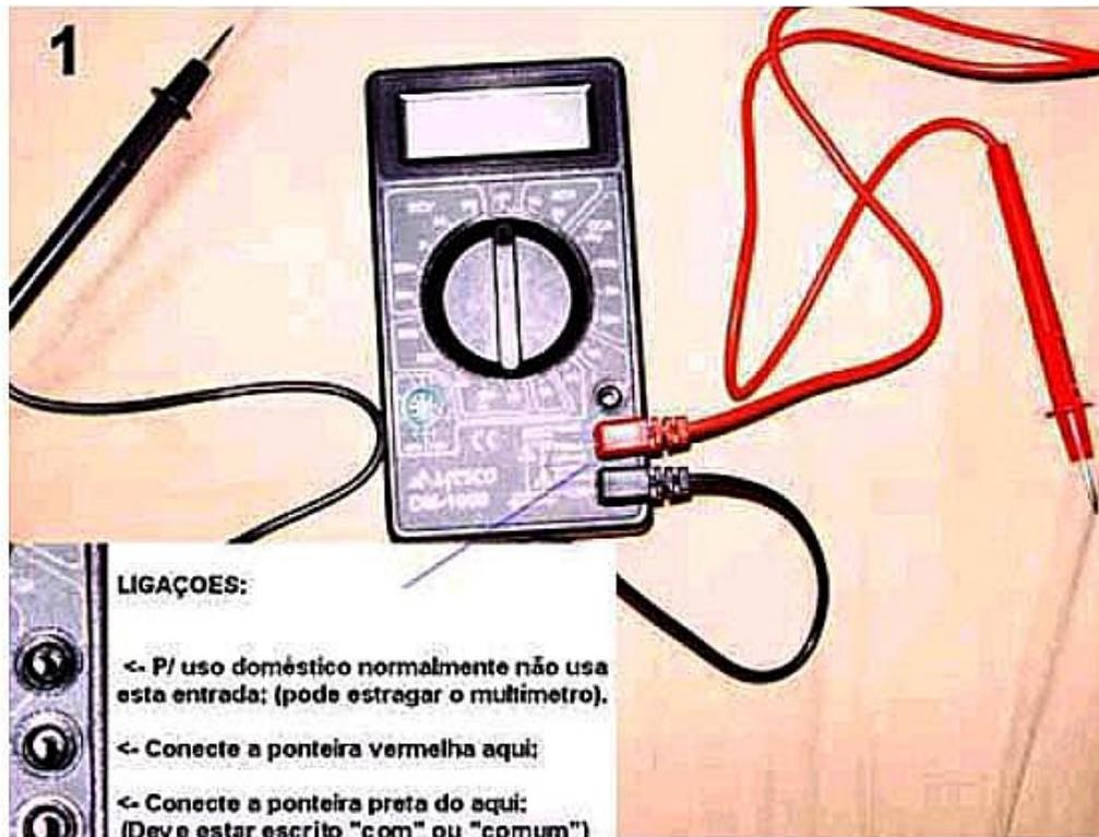
3- Feito isto, localize o campo no multímetro que mede resistência. É o campo onde está o símbolo de OHM – ômega ( $\Omega$ ). Geralmente localiza-se na parte esquerda inferior.
