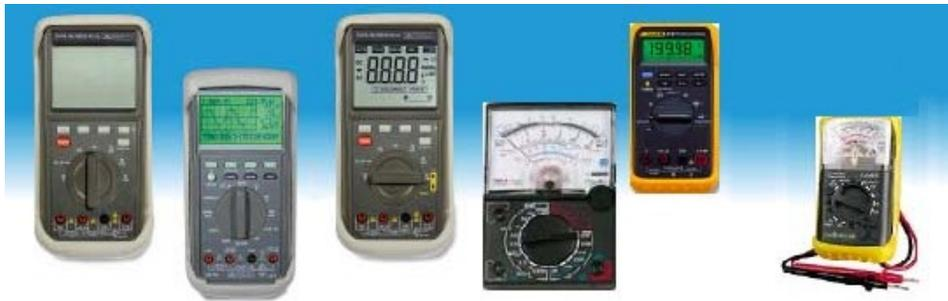
Basicamente, o multímetro ou multitester é o aparelho usado para medir tensão ou corrente contínua (DCV), tensão ou corrente alternada (ACV), além de resistência elétrica ( $\Omega$ ). A função do multímetro pode ser escolhida através da chave redonda localizada no centro da peça. Existem dois tipos de multímetro: o analógico (com ponteiro) e o digital (com visor de cristal líquido).
