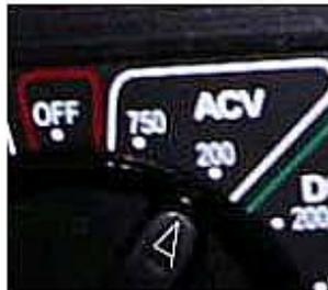
3 - Se a região a ser analisada trabalha com 220v, posicione o multímetro em 750v, se a região trabalha com 110v, posicione o multímetro em 200v para fazer a medição conforme foto abaixo. Tendo compreendido isto e com o multímetro em off (desligado), introduza em qualquer ordem as ponteiros em cada um dos orifícios da tomada e gire o ponteiro do multímetro até a posição mais apropriada. Sempre segure as ponteiros pelos cabos plásticos.
