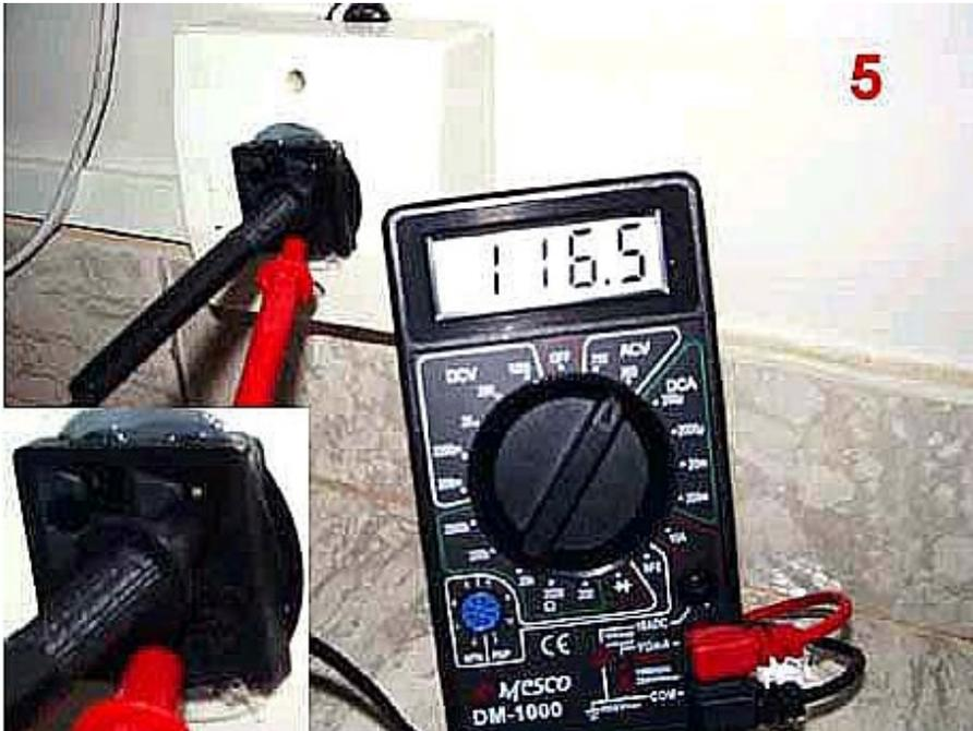
Passo 1 - A medição inicial do aterramento é feita entre o orifício da fase e o orifício do terra – foto 5.
