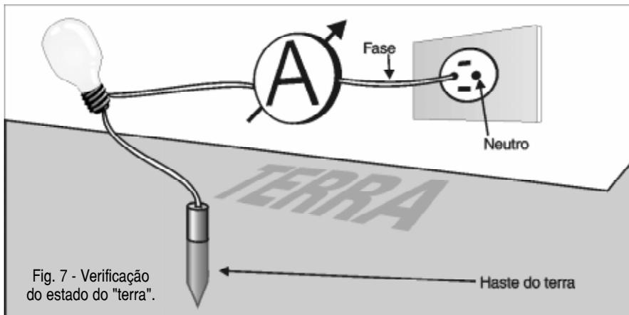
Fig. 7 - Verificação do estado do "terra".
